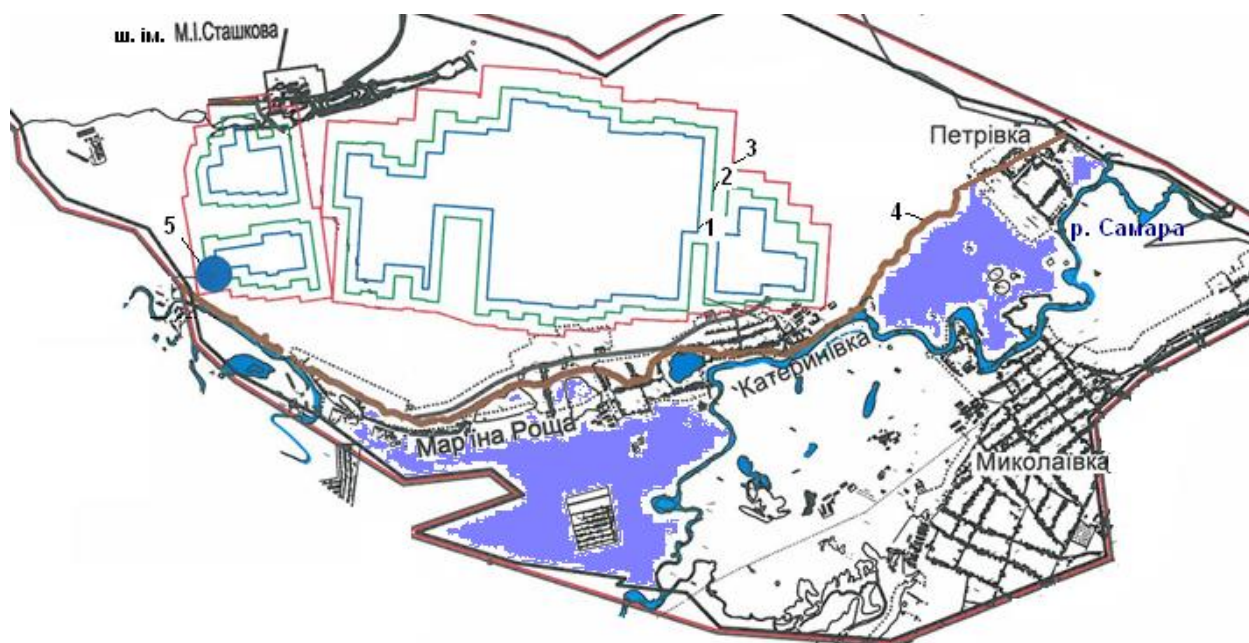
Рис. 18 Фрагмент ділянки шахтного поля: 1, 2, 3 – проєкції пласта S_5 на денну поверхню, відповідно, плаского дна, контуру пласта та зони впливу; 4 – межа зони потенційного підтоплення; 5 – зона розташування водозабірних свердловин
