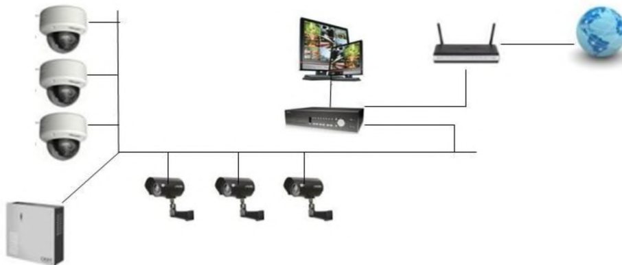
Рисунок 1.3.1 – Типова схема підключення аналогового відеоспостереження
