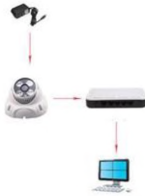
Рисунок 1.3.4.1 – Схема запису інформації на комп'ютер
