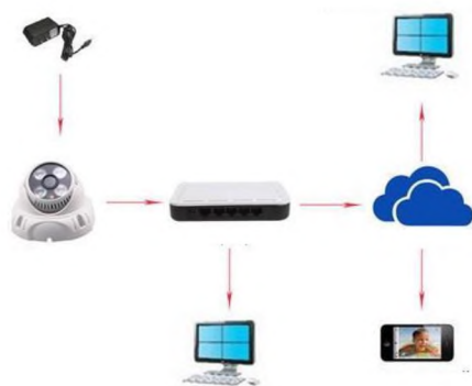
Рисунок 1.3.3 – типова схема роботи IP-системи відео нагляду
