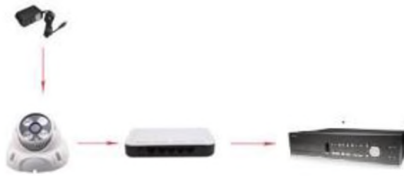
Рисунок 1.3.4.2 – спосіб передачі інформації на відео реєстратор
