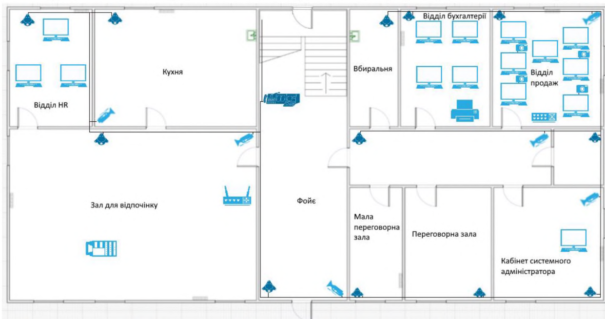
Рисунок 1.4 – Генеральний план першого поверху ОІД із лініями мережі
