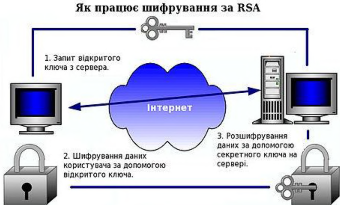
Рисунок 2.2 - Схема шифрування RSA
