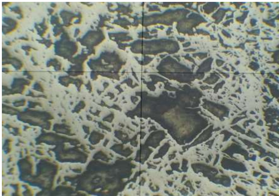
Рис. 3.4 – Чарункова мікротекстура гетит-гідрогетитових агрегатів в руді. Аншлиф, зб.90.
