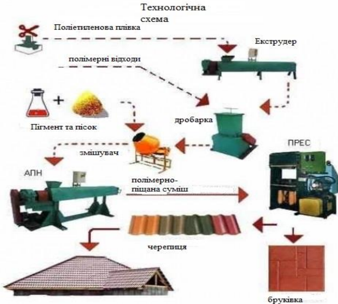
Рисунок 2.11 – Технологічна схема отримання виробів з полімер піщаної суміші
