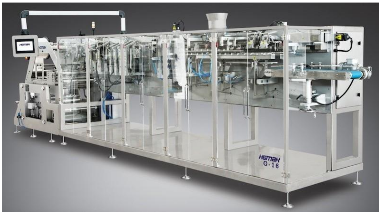
Рисунок 1.3 – Приклад обладнання для виробництва пакування дой-пак
