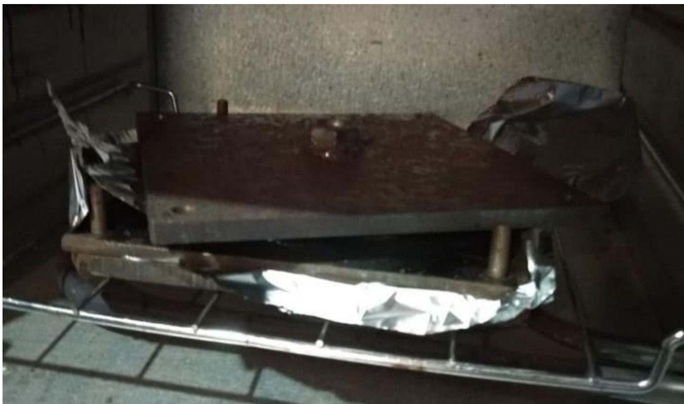
Рисунок 2.9 – Термоформування подрібненого дой-паку в електричній духовці
