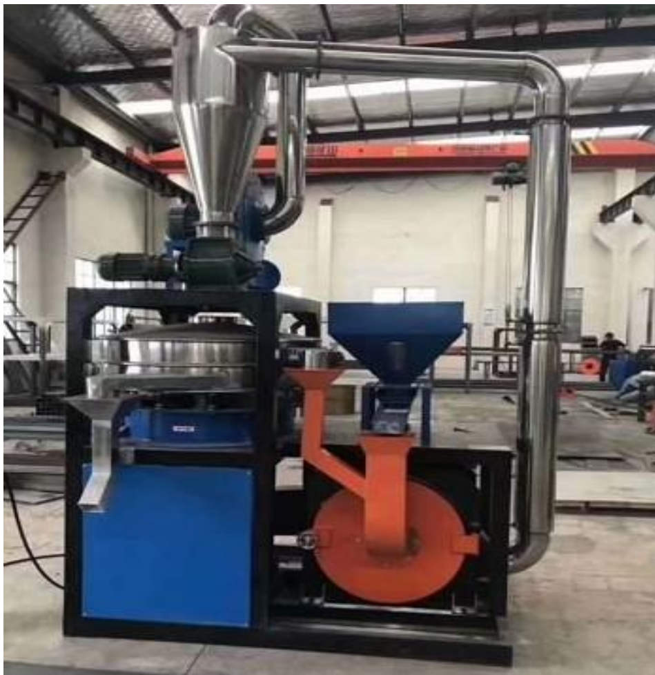
Рисунок 3.7 – Роторно-вихровий млин тонкого помолу для переробки полімерів
