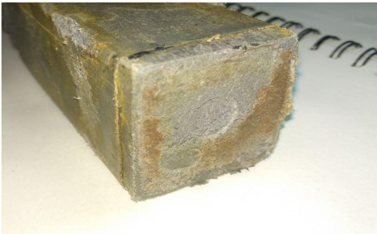
Рисунок 2.7 – Пластиковий брус 34/34мм, виготовлений з дой-паку
