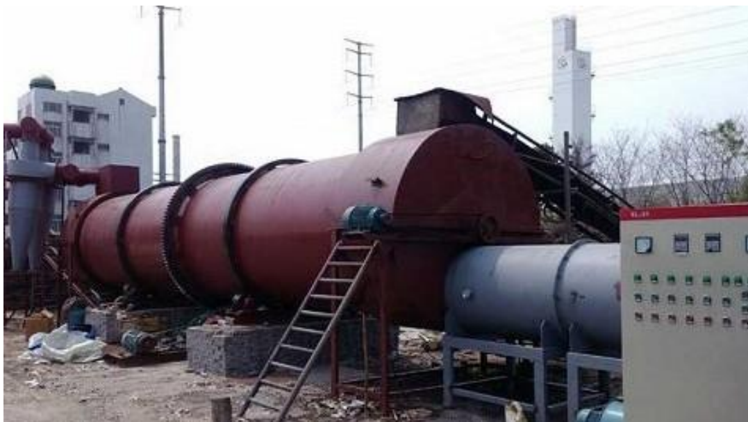
Рисунок 3.4 – Приклад піролізної установки для переробки пластику
