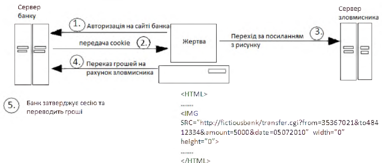
Рисунок 2.3 – схема CSRF атаки
