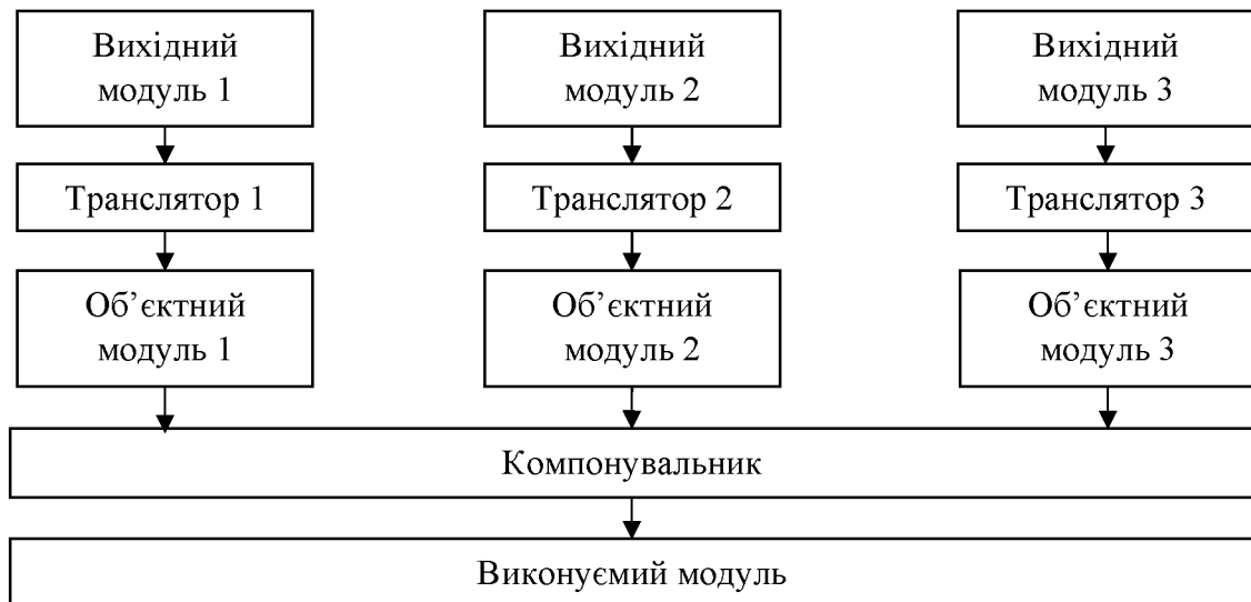
Рисунк 1.5 – Приклад схеми об'єднання модулів, створених із застосуванням різних мов програмування
