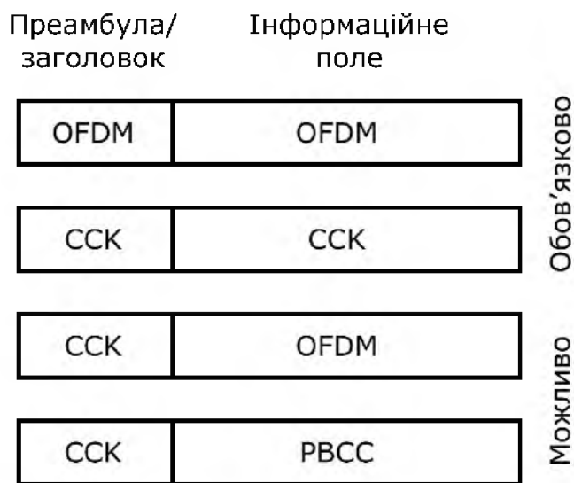
Рисунок 1.12 - Кадри IEEE 802.11g у різних режимах модуляції
