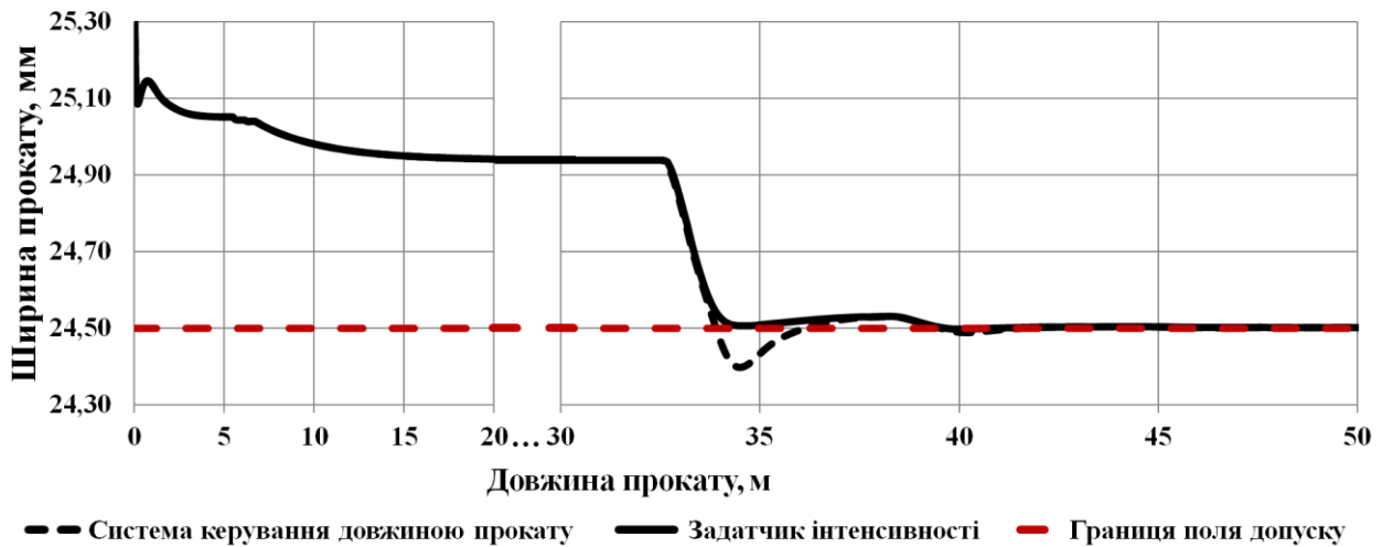
Рисунок 7 – Профілеграма переднього кінця прокату отримана при використанні задатчика інтенсивності на базі ПІ-регулятора
