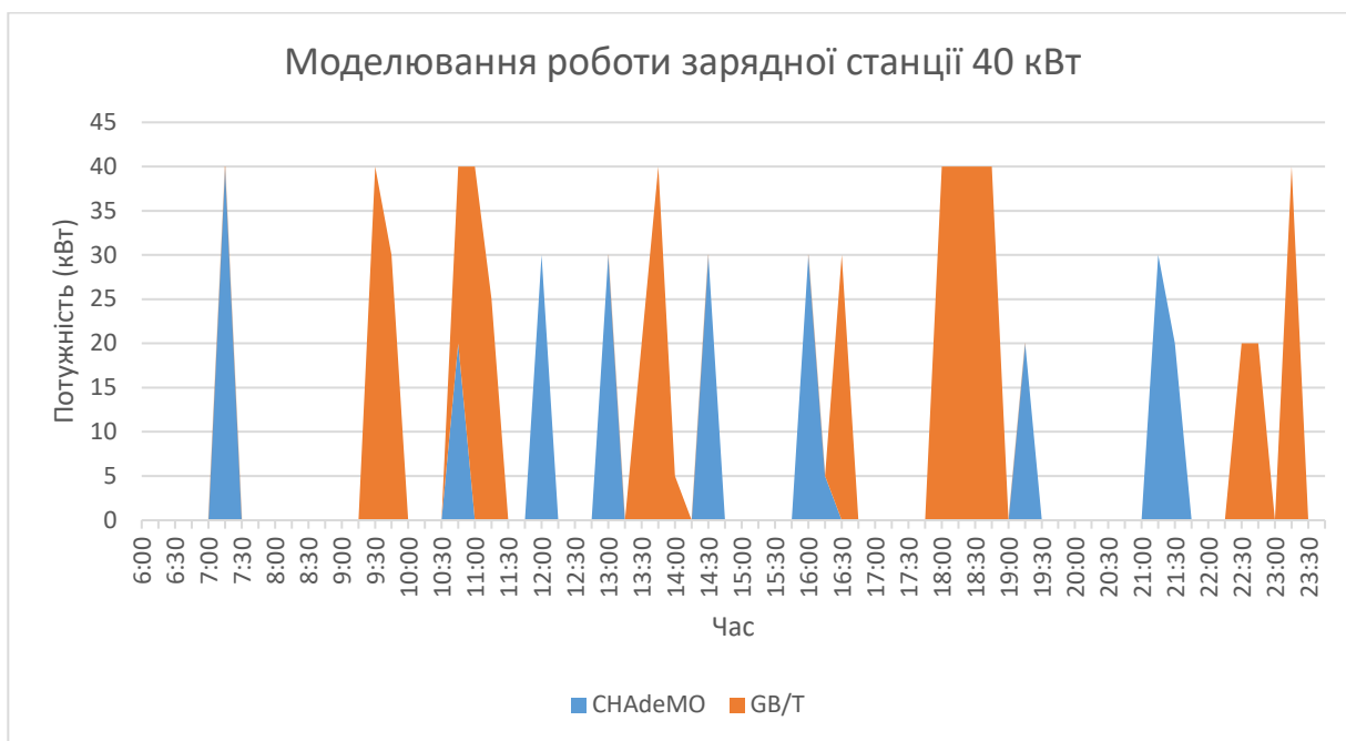
Рисунок 2.2.1 – Моделювання роботи зарядної станції потужністю 40 кВт
