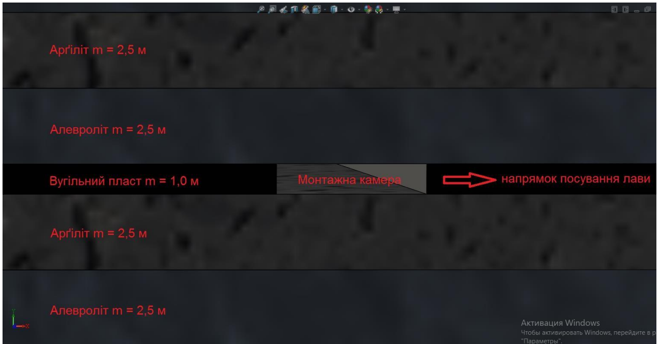
Рисунок Д.1 – Пісковик у покрівлі відсутній
