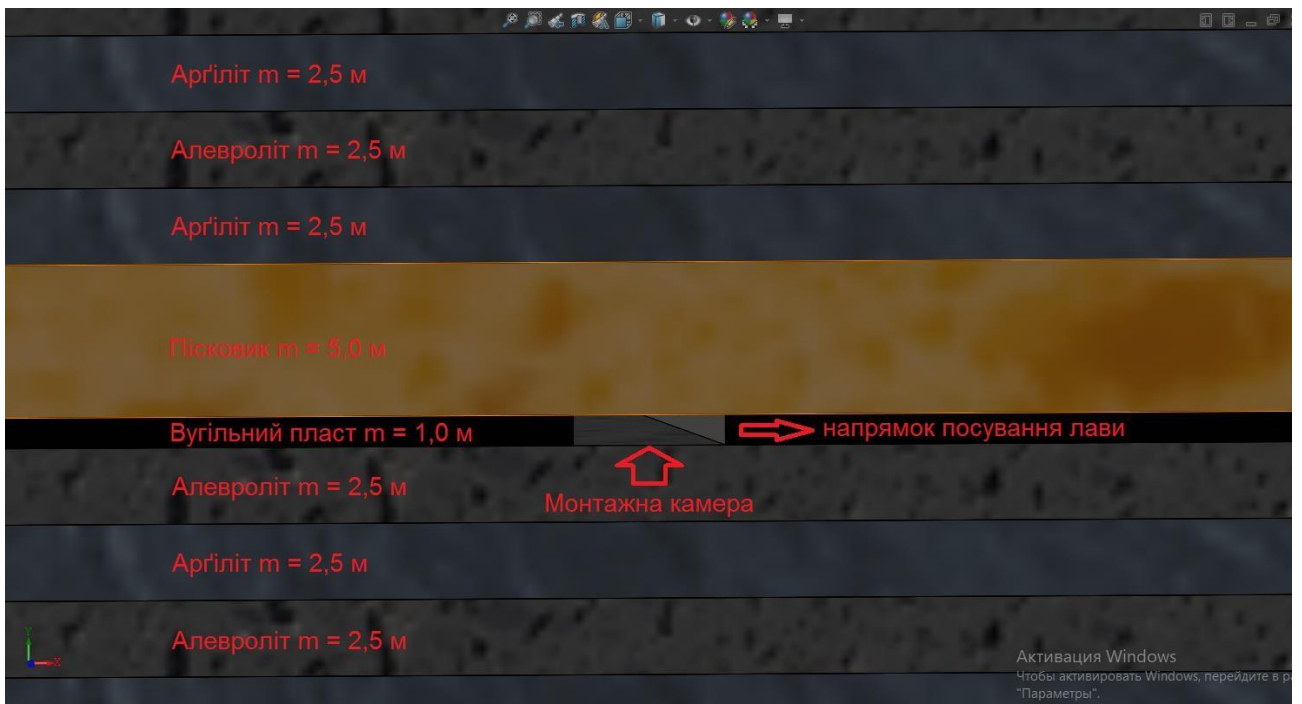
Рисунок Д.2 – Залягання пісковика потужністю 5,0 м у безпосередній покрівлі
