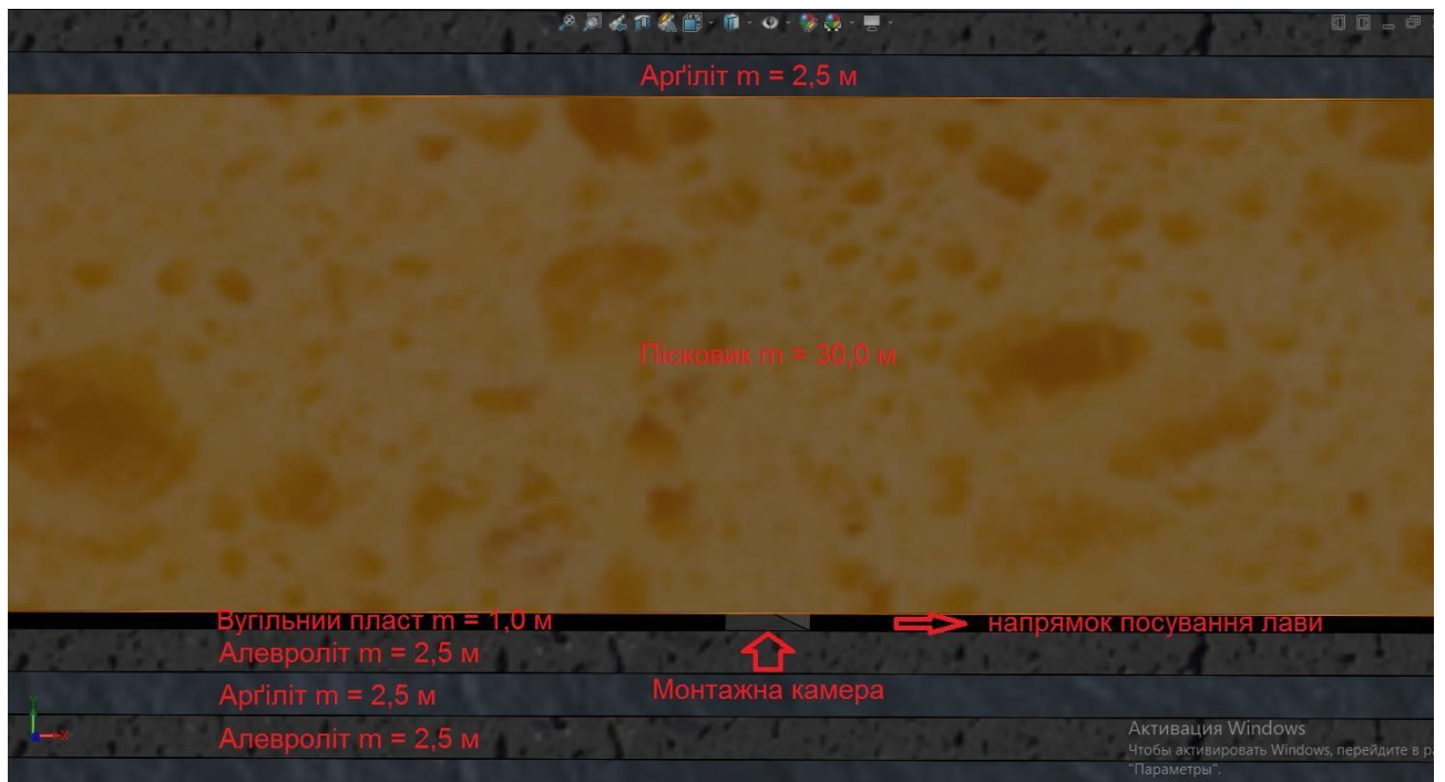
Рисунок Д.4 – Залягання пісковика потужністю 30,0 м у безпосередній покрівлі
