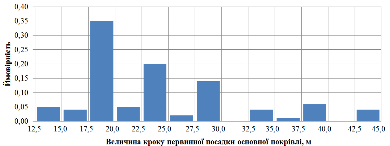
Рисунок 2.2 – Статистичний аналіз кроку первинної посадки основної покрівлі для умов шахт Західного Донбасу
