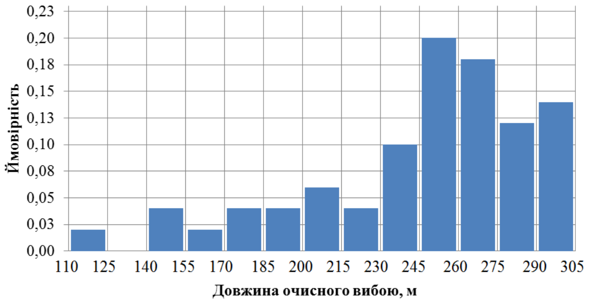
Рисунок 2.1 – Статистичний аналіз довжини очисних вибоїв для умов шахт Західного Донбасу
