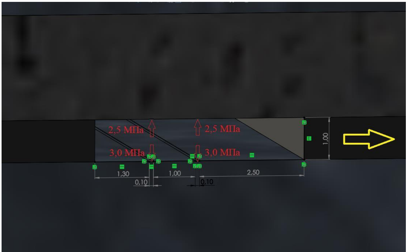
Рисунок И.3 – Параметри моделювання очисної виробки
