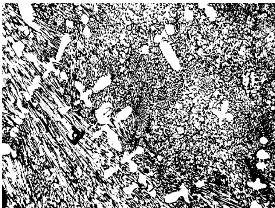
Рис. 2. Лита структура чавуну ІЧ230Х28ГЗС, \times 100
