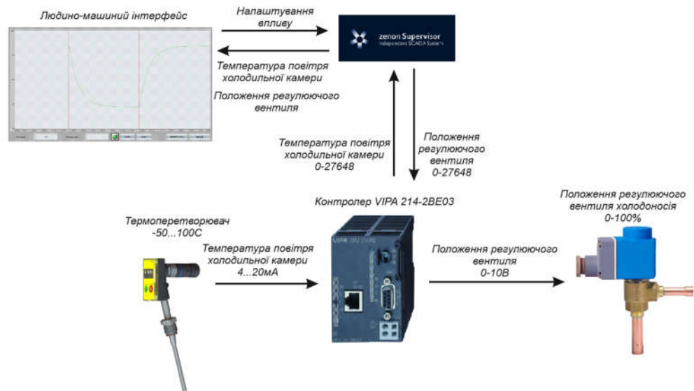
Рисунок 2.1 – Система дослідження роботи холодильної камери
