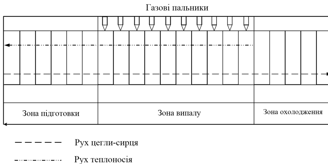
Рисунок 1.7 – Схема обпалювального каналу тунельної печі
