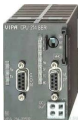
Рисунок 1.6 – Програмований логічний контролер VIPA 214-2BS33
