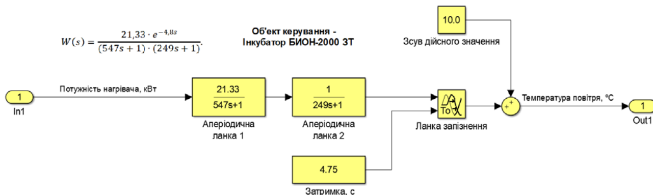
Рисунок 3.17 – Модель об'єкту керування (Інкубатор БІОН-2000 ЗТ)
