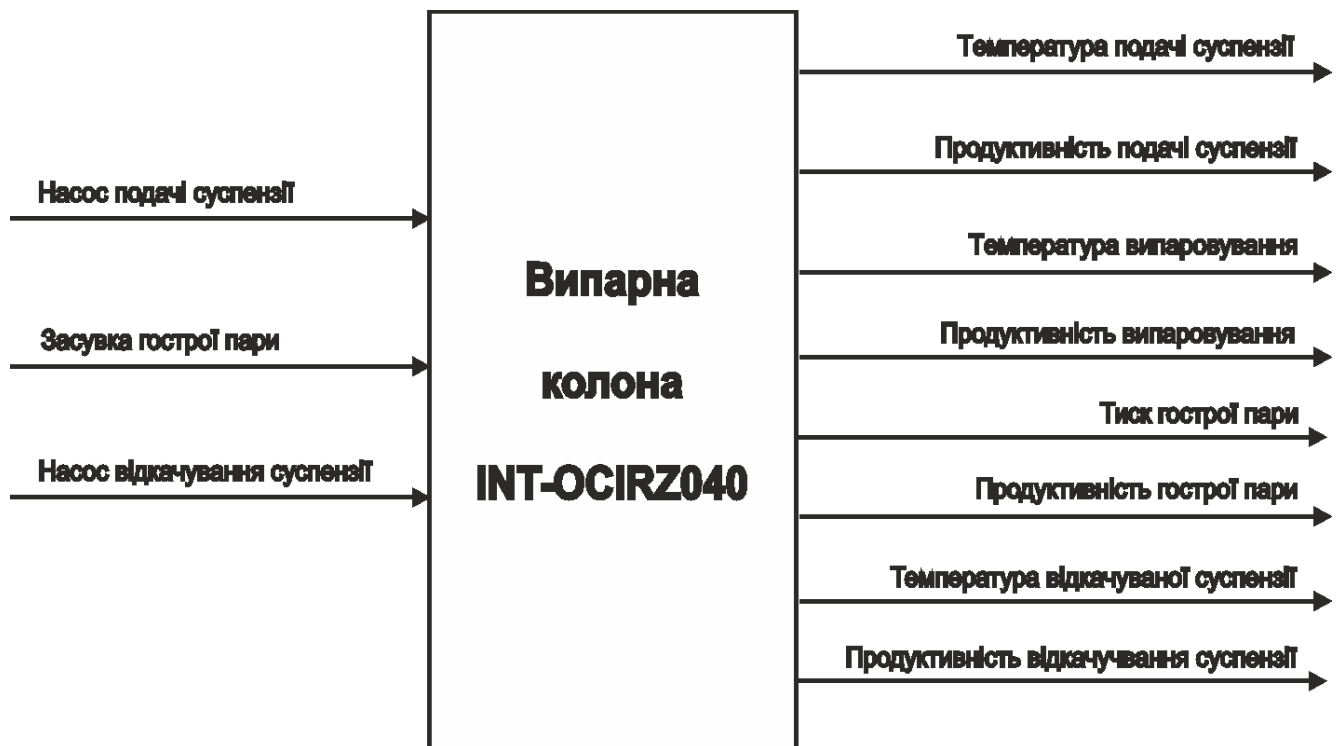
Рисунок 1.9 – Структура об'єкту керування - схема випарної колони INT-OCIRZ040
