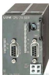
Рисунок 2.10 – Програмований логічний контролер VIPA 214-2BS33
