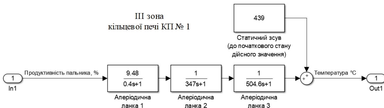
Рисунок 3.14 – Модель об'єкта керування - III зона кільцевої печі № 1
