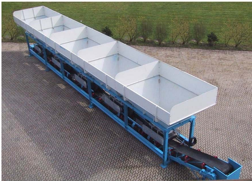
Рисунок 5.2 - Конвеєр для переміщення матеріалу у сушарку
