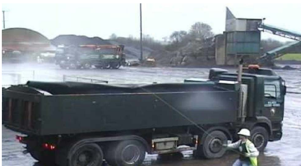
Рисунок 5.4 - Вантажівка з ізольованим кузовом, що перевозить асфальт, потім накривається перед виїздом з майданчика
