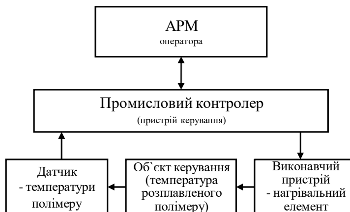
Рисунок 2.1 – Зображення схеми структурної системи автоматизації температурного режиму екструдера
