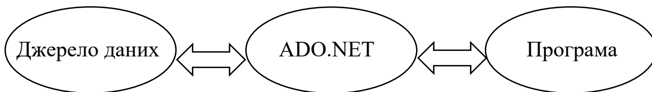
Рис. 2.3. Схема взаємодії програми з БД за допомогою ADO.NET
