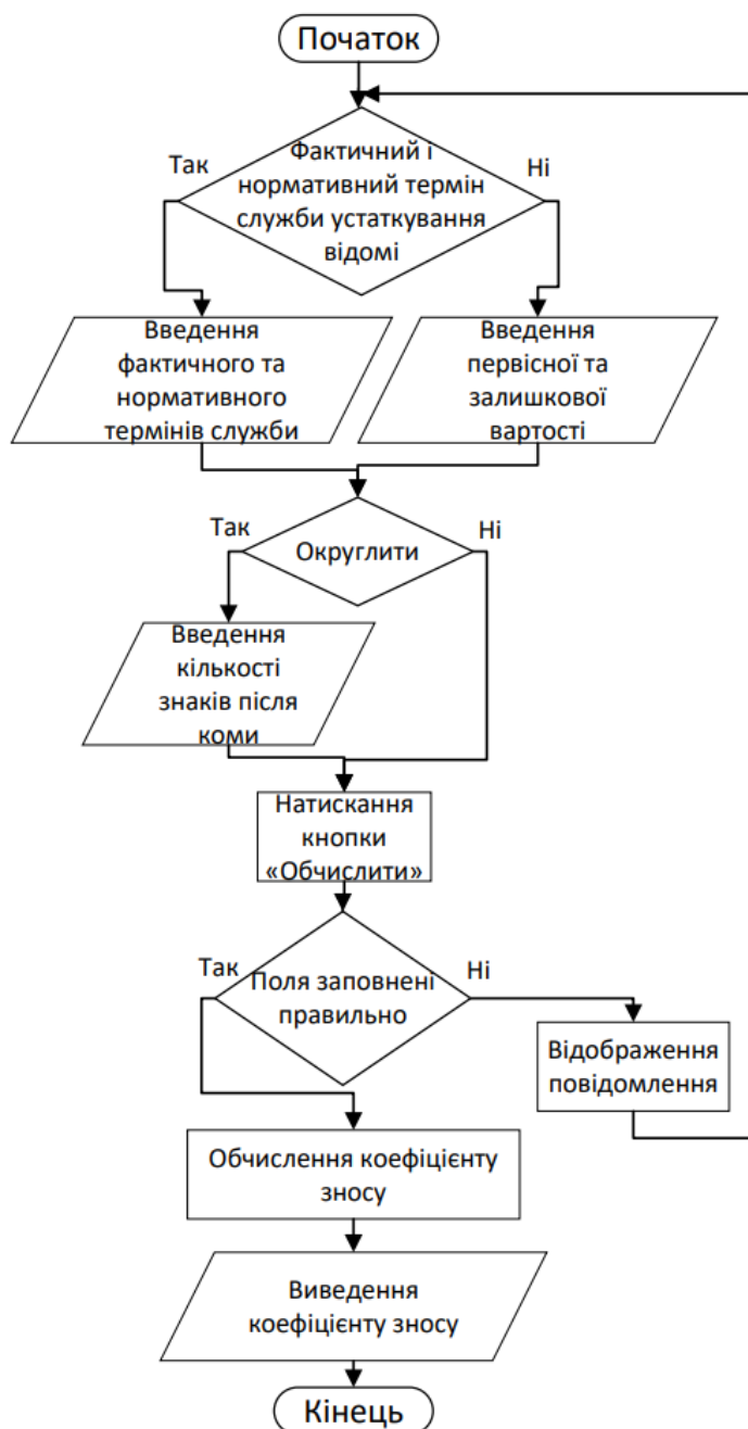
Рис. 2.8. Блок-схема алгоритму роботи екрану розрахунку коефіцієнта зносу
