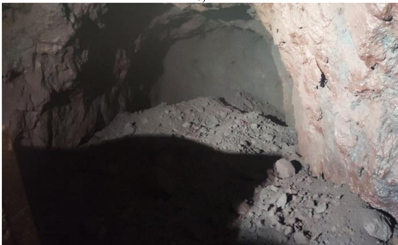
Рис. 3. Фотофіксація вибою орту горизонту 910 м до вибуху (а) та після вибуху (б) за розрахованими параметрами БПР в умовах ПрАТ «ЗЗРК»
