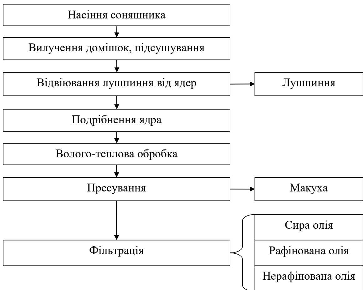
Рисунок 2.1 – Алгоритм переробки насіння соняшника
