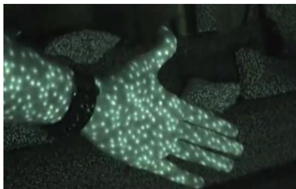
Рис.1.3. Візерунок точок, спроекційованих сенсором глибини у інфрачервоному діапазоні
