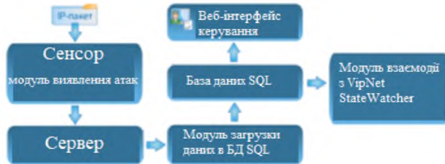
Рисунок 2.7 - Схема взаємодії компонентів ПЗ ViPNet IDS
