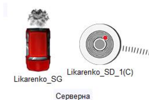
Рисунок 5.8 – Датчик диму виявив дим і ввімкнув сирену
