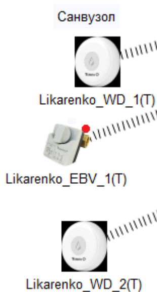
Рисунок 5.14 – Результат тестування зупинки передачі сигналу та утримання клапана з електроприводом у закритому стані після активації датчика затоплення
