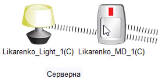
Рисунок 5.6 – Датчик руху передає сигнал і освітлення ввімкнене
