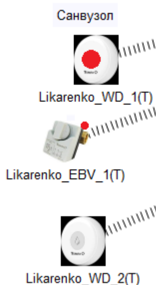
Рисунок 5.13 – Результат тестування переходу клапана з електроприводом у закрите положення після отримання сигналу від датчика затоплення
