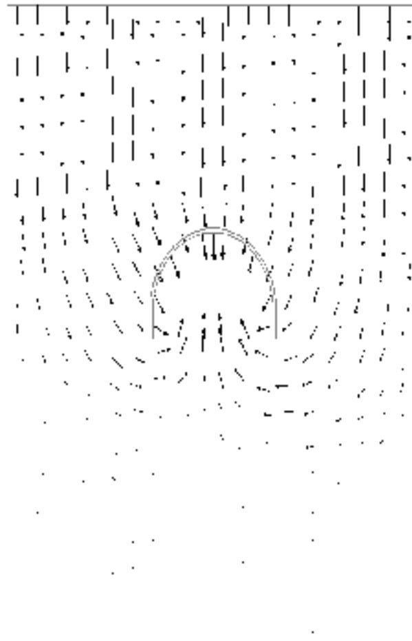
Рис. 3.3. Векторне подання епюр повних переміщень вуглевміщуючих породних шарів в околиці пластової виробки.
