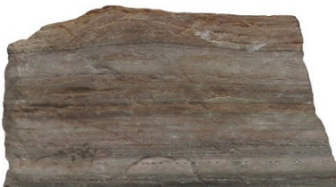
Рис. 4.2. Приклад масиву з порушеними контактами між сусідніми літотипами
