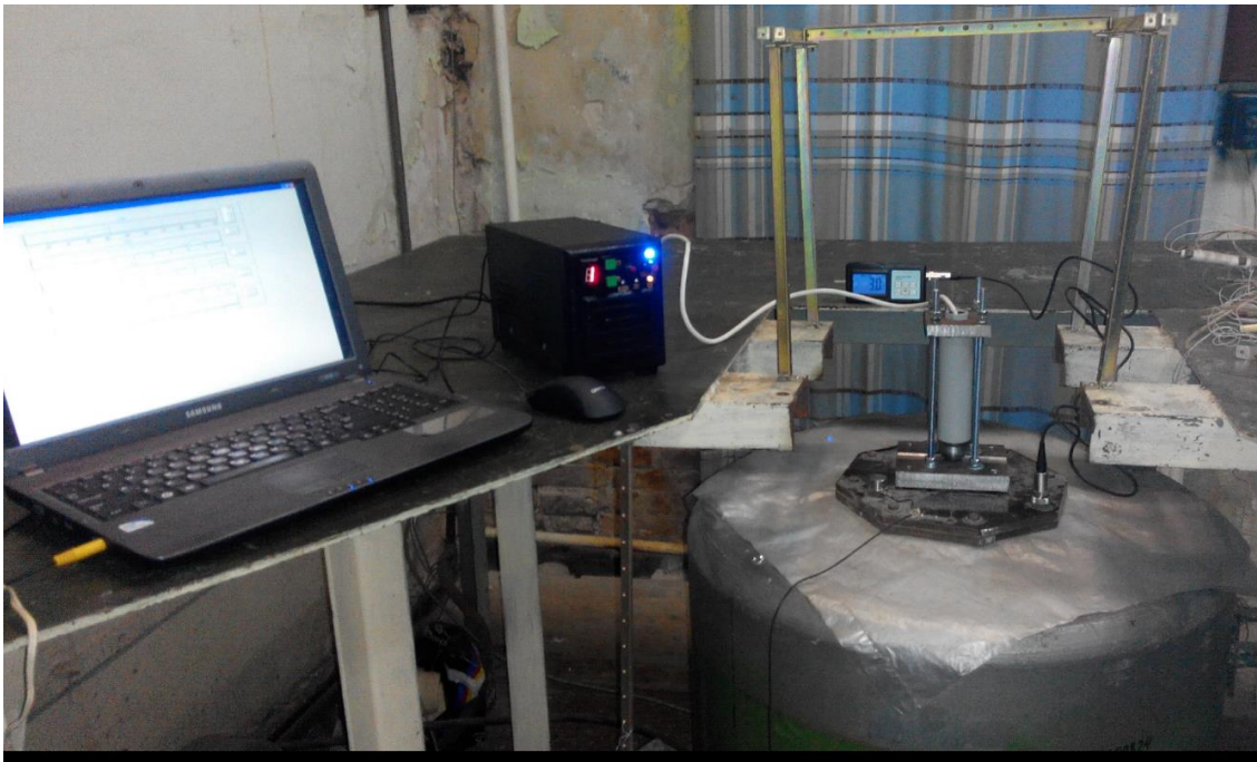
Рисунок 5.8 – Випробування апаратно-програмного комплексу на вібраційному стенді ВЕДС-400А
