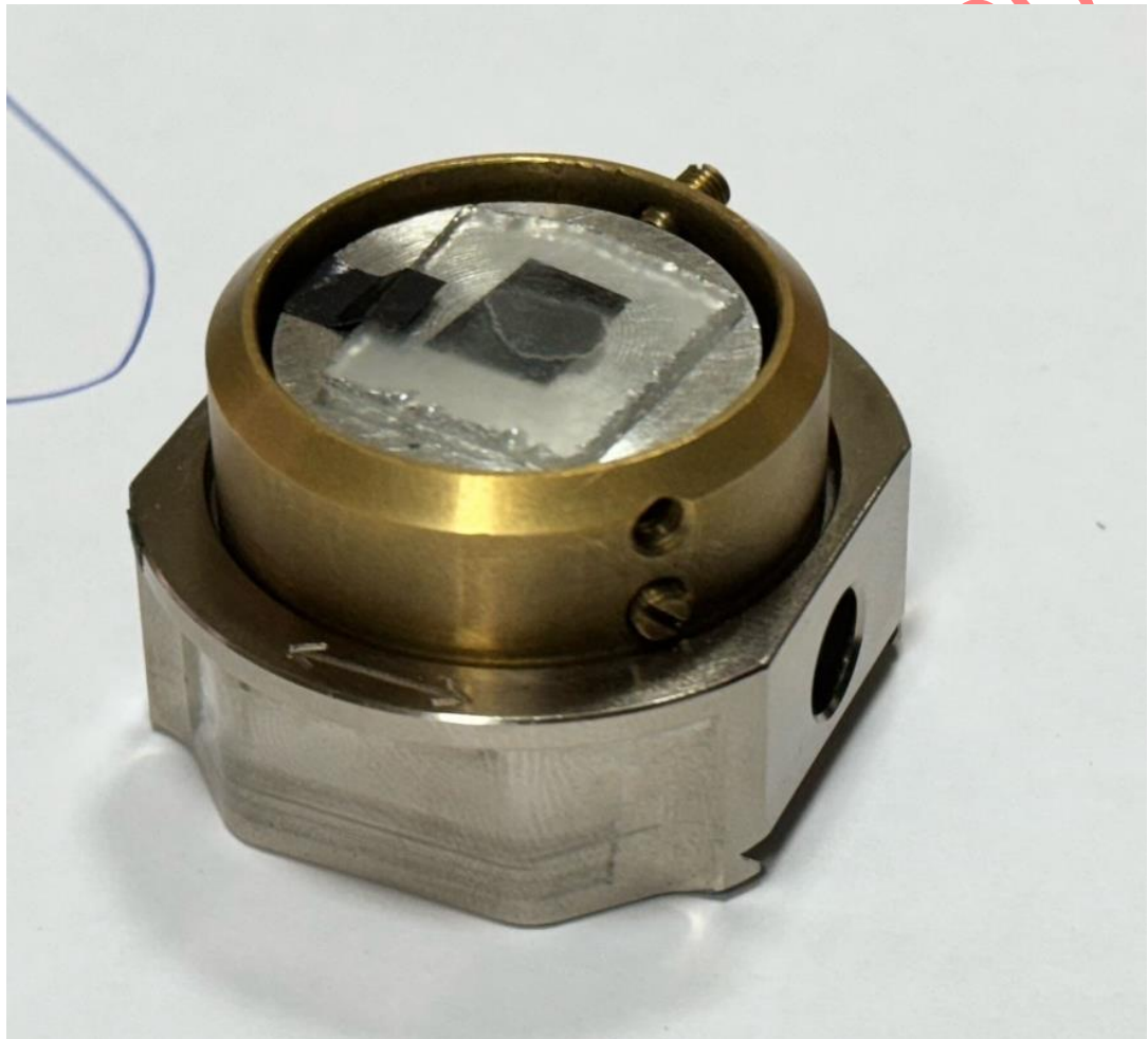
Рисунок 2.5 – Покриття проби шаром платини
