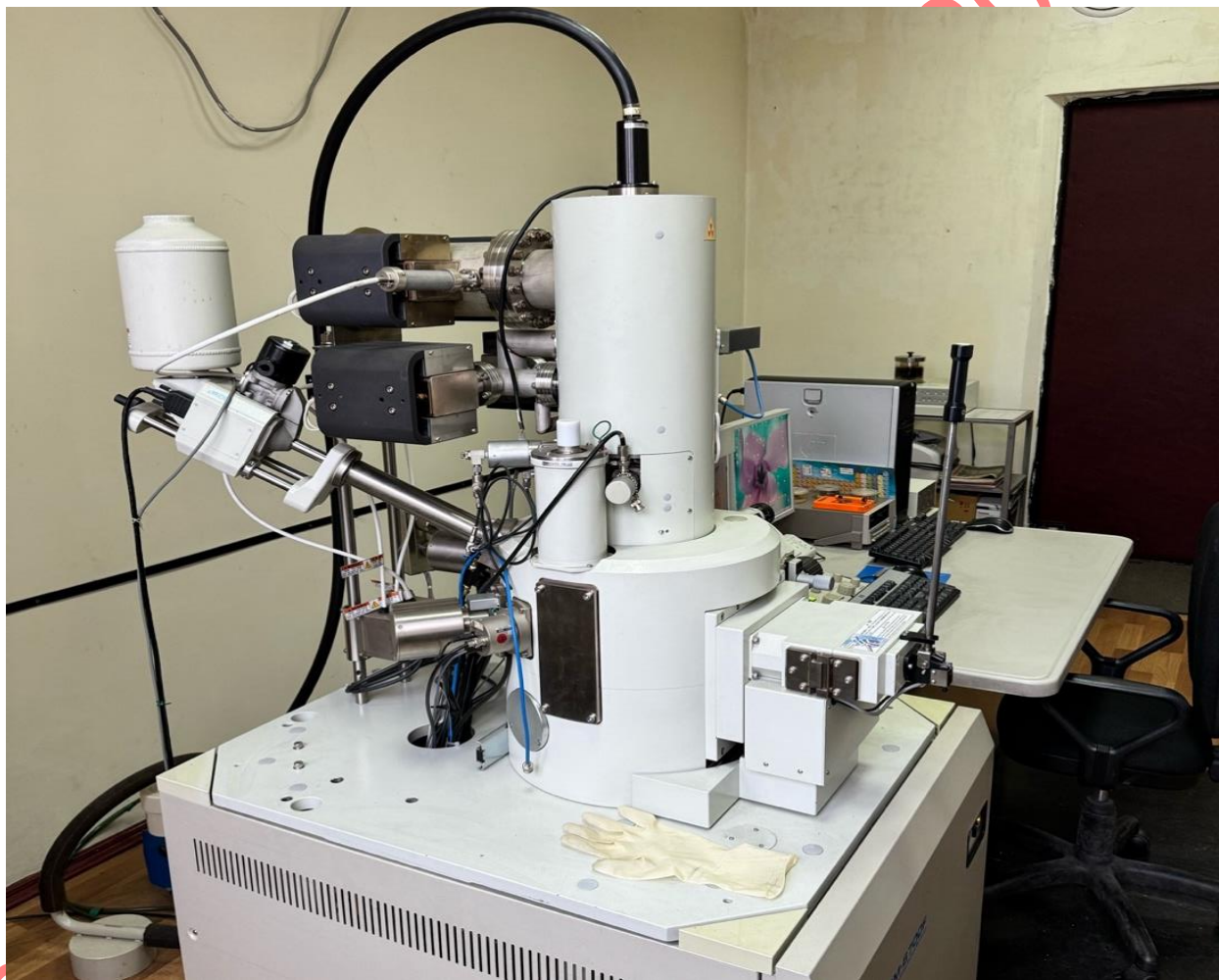
Рисунок 2.2 – Скануючий електронний мікроскоп JSM-6700F з енерго-дисперсійною системою для мікроаналізу
