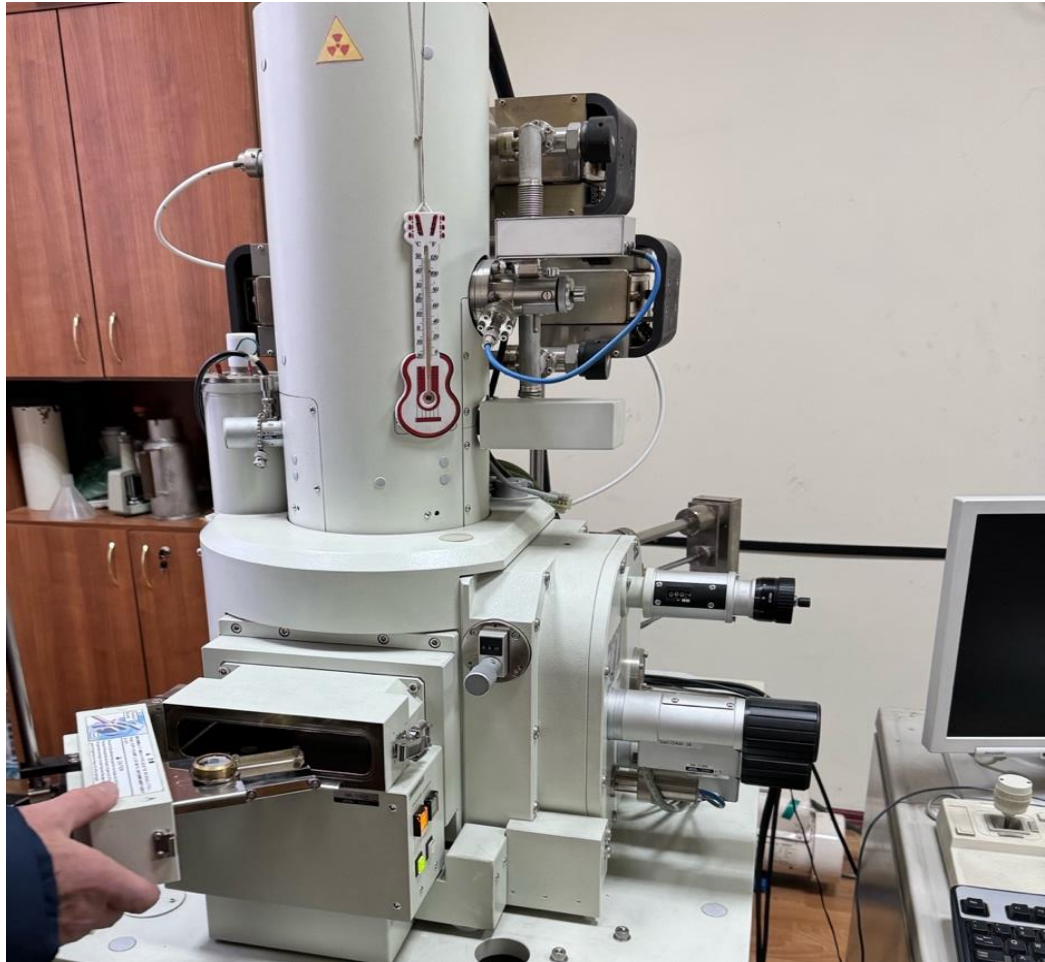
Рисунок 2.4 – Скануючий електронний мікроскоп JSM-6700F у завантажувальній фазі
