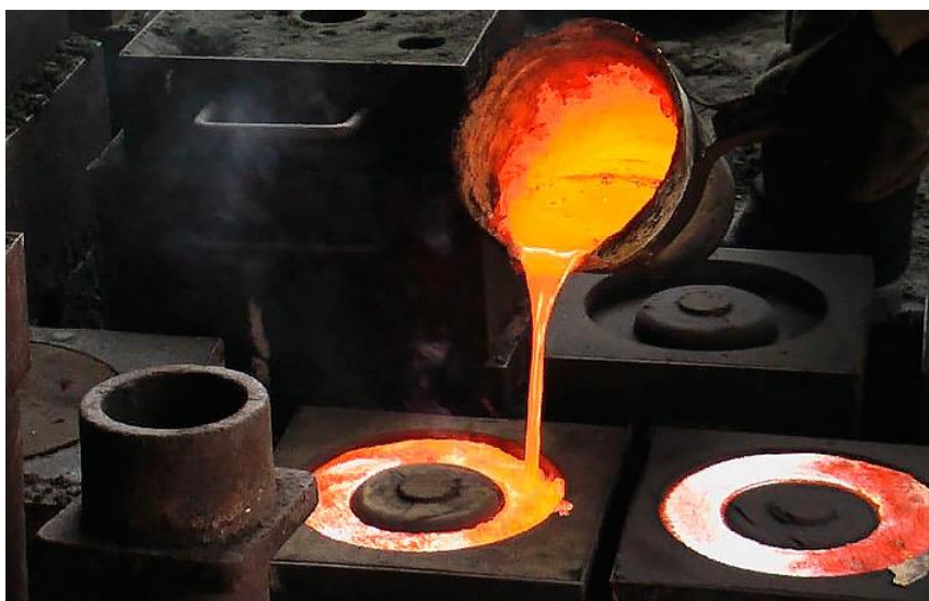
Рис. 1.1. Лиття в піщано-глинисті форми
