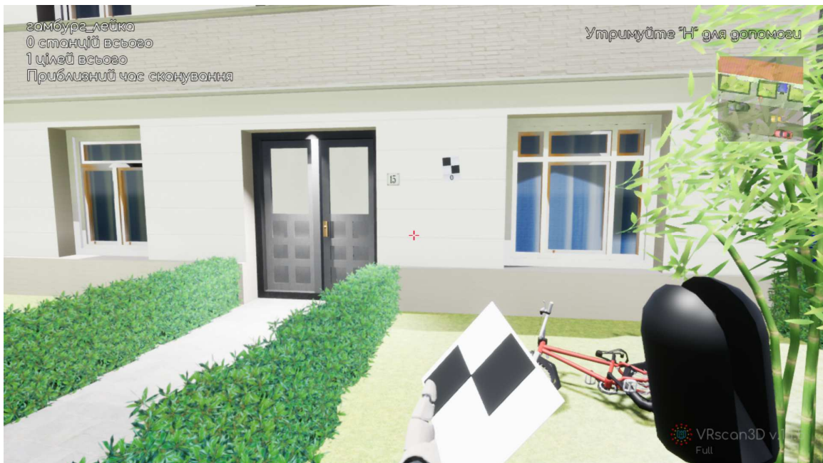
Рисунок 1.7 – Розміщення марок для сканування
