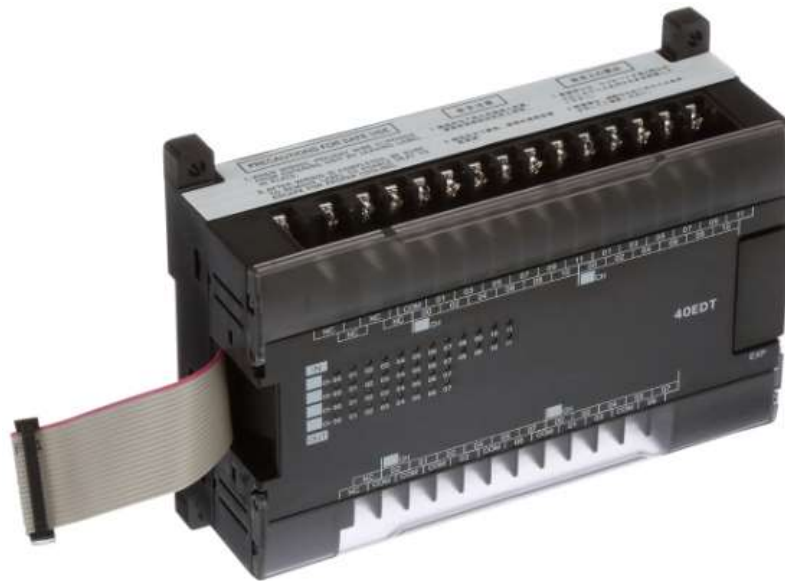
Рисунок 2.2 – Модуль дискретних входів/виходів, OMRON CP1W-40EDT[10]
