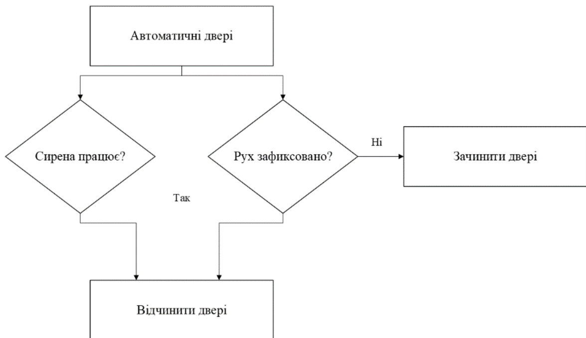
Рисунок 4.7 – Алгоритм роботи автоматичних дверей
