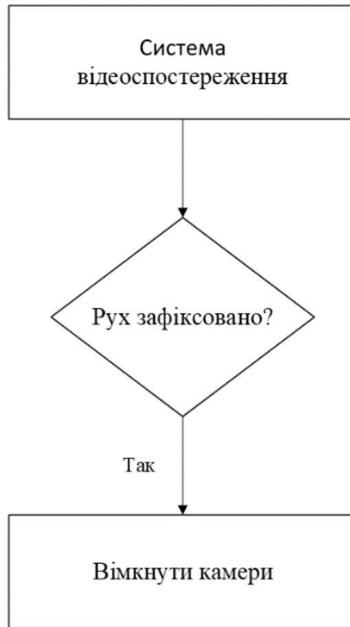
Рисунок 4.4 – Алгоритм роботи системи відеоспостереження
