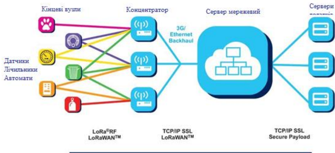
Рисунок 4.8 – Структура мережі LoRaWAN
