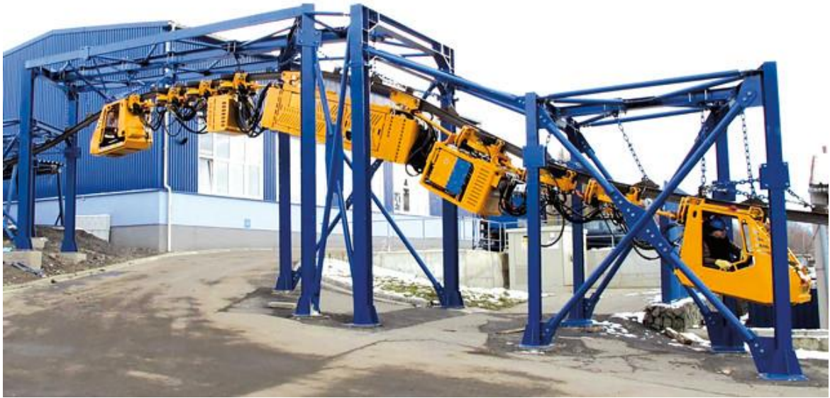
Рисунок 2.12 – Стендові дослідження адаптаційної здатності ПДМ
