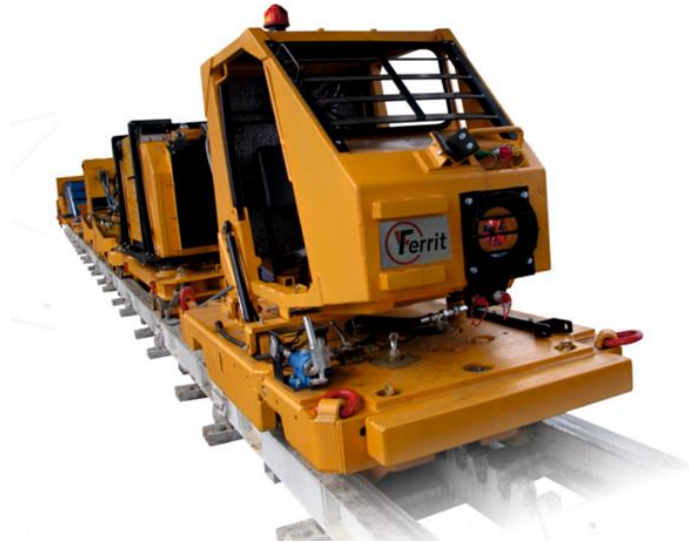
Рисунок 2.9 – Шахтний надгрунтовий зубчастий локомотив фірми «Ferrit»
