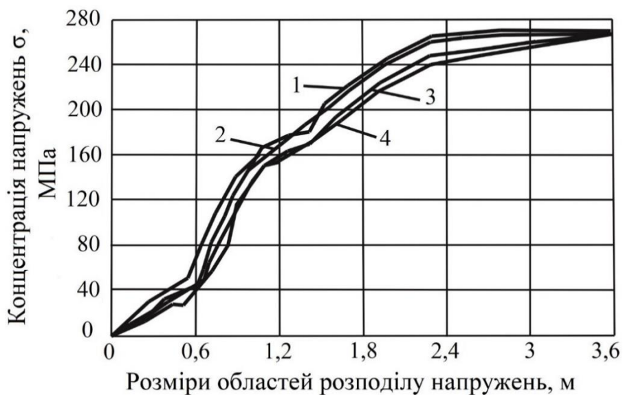
Рисунок 3.7 – Концентрація напружень \sigma_{\max} при різному виді кріплення відповідно: 1 – базове металеве кріплення, 2 – композитне кріплення D33, 3 – композитне кріплення D36, 4 – композитне кріплення D39
