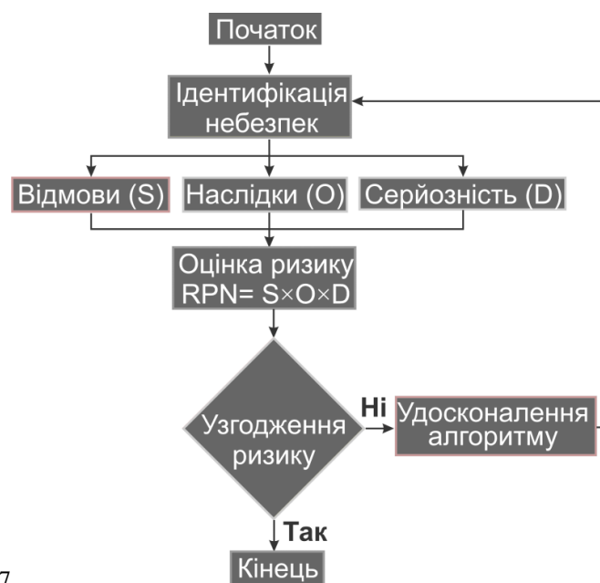
Рис. 2.17 Алгоритм дій при проведенні оцінювання методом "FMEA" [24]
