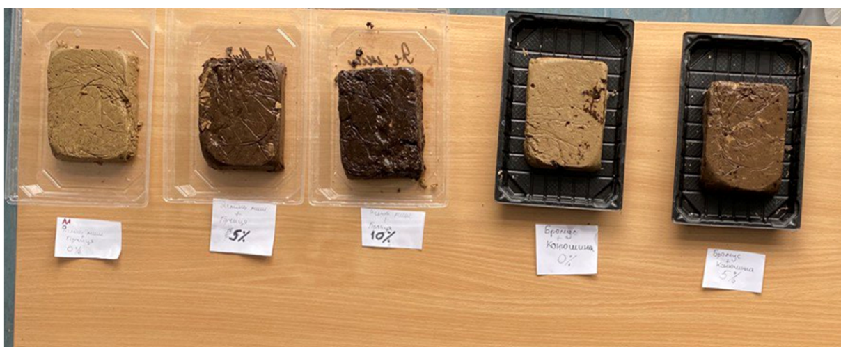
Рисунок 4.3 – Композитні брикети з досліджуваними рослинами (1-ий день)
