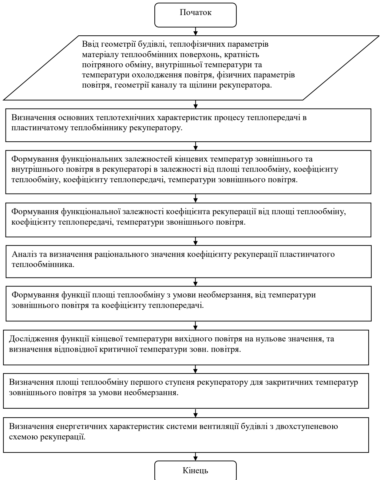
Рисунок 2.12 – Блок-схема алгоритму функціонування автоматизованої технології утилізації тепла системи вентиляції за допомогою рекуператора
