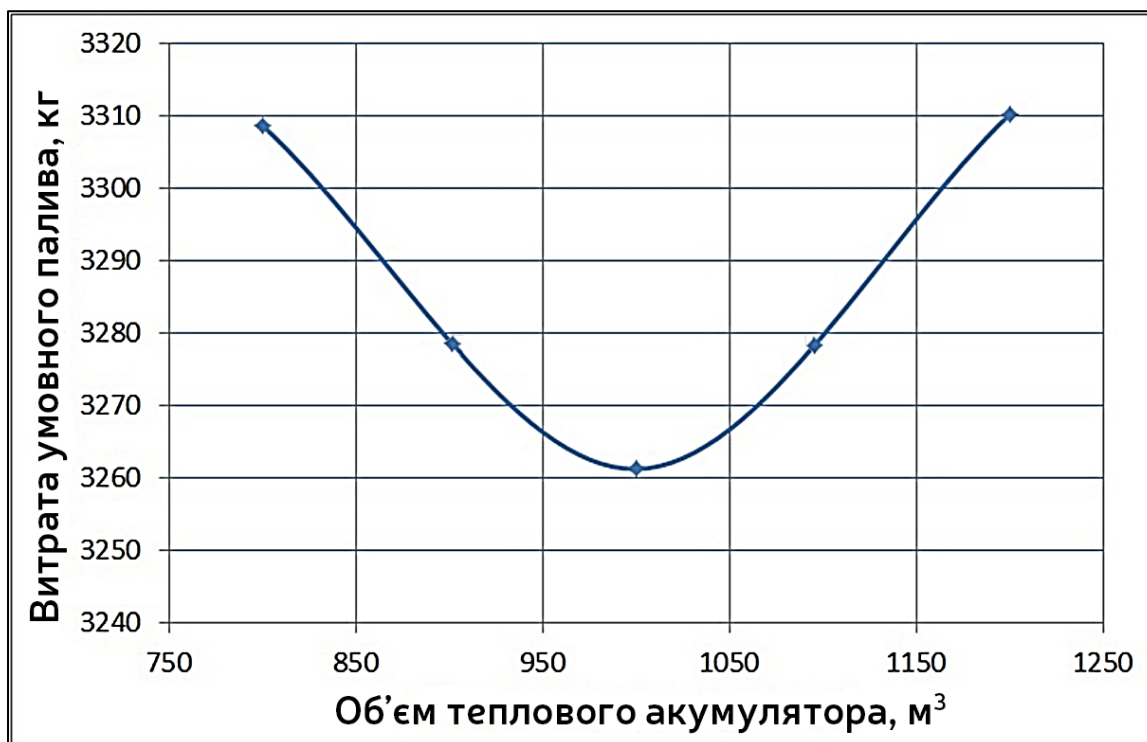
Рисунок 2.34 – Залежність сумарних витрат умовного палива від об'єму ТА для комплексної системи кондиціонування та опалення
