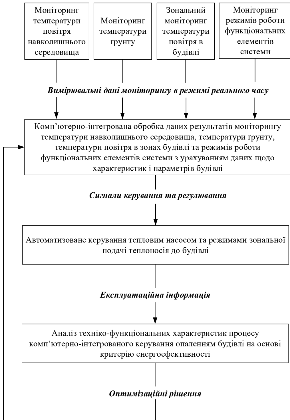
Рисунок 3.2 – Блок-схема реалізації інформаційної моделі енергоефективного комп'ютерно-інтегрованого керування опаленням будівель
