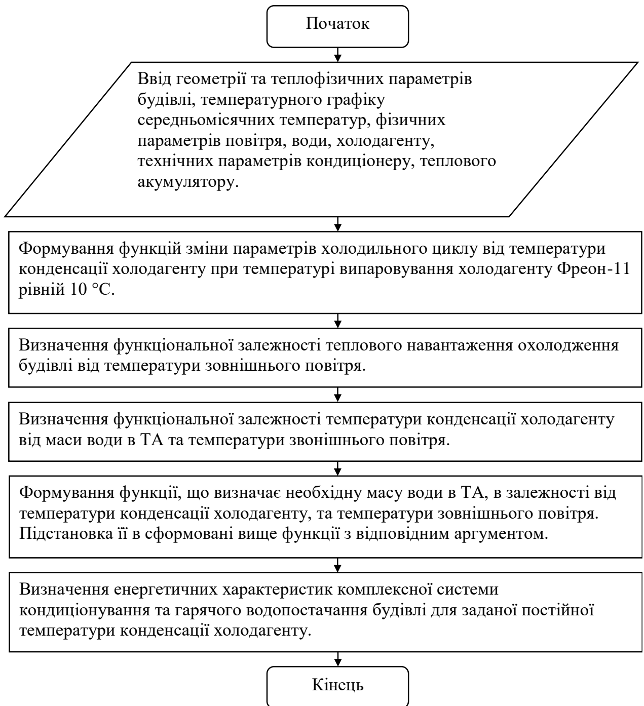
Рисунок 2.2 – Блок-схема алгоритму функціонування автоматизованої технології утилізації тепла з постійним об'ємом теплового акумулятора та змінною температурою конденсації холодагенту
