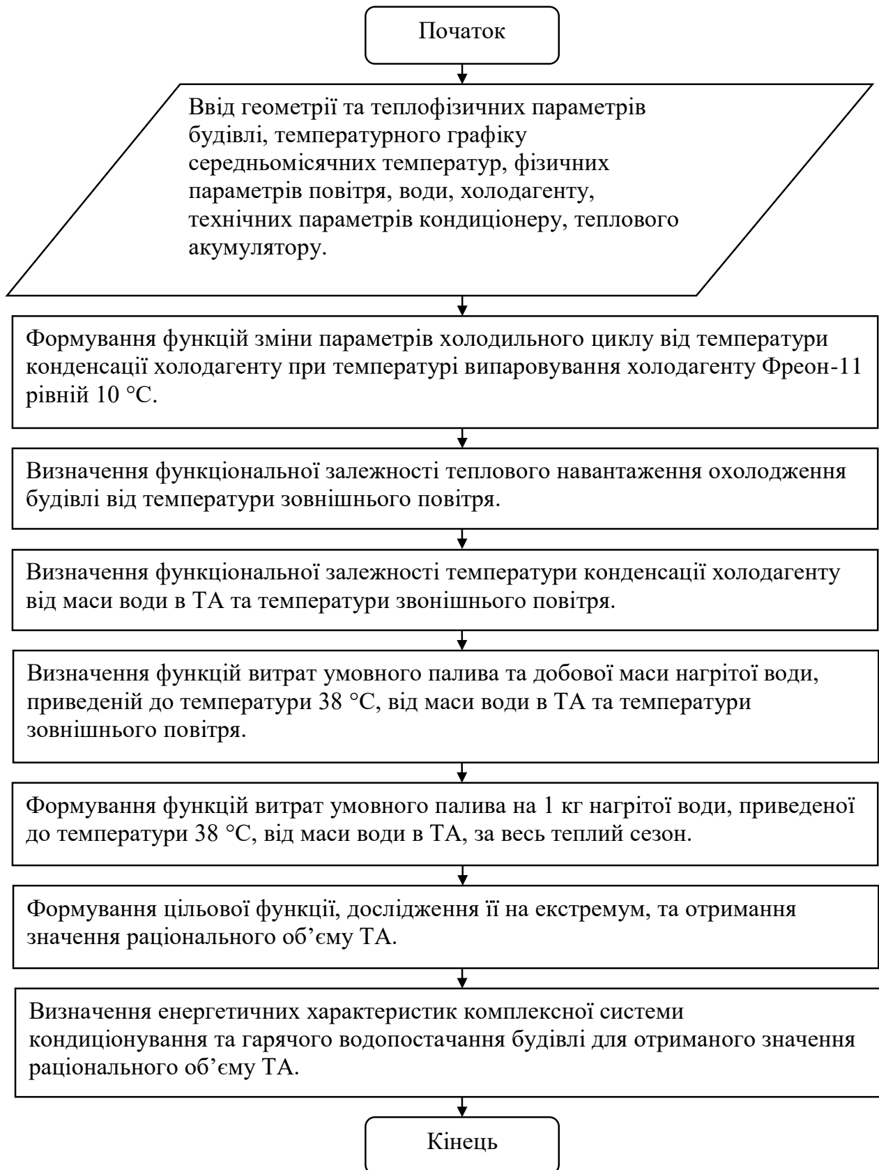
Рисунок 2.3 – Блок-схема алгоритму функціонування автоматизованої технології утилізації теплоти зі змінним об'ємом теплового акумулятора та постійною температурою конденсації холодагенту
