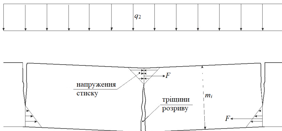
Рисунок 4.2 – Схема до розрахунку стійкості розпірної системи з двох породних блоків
