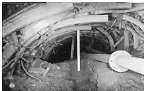
Рисунок 3.2 – Положення траси шахтового газопроводу в просторі гірничої виробки
