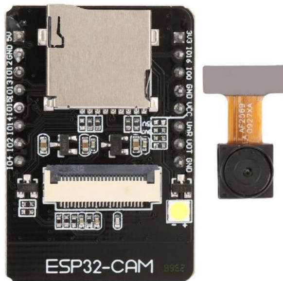
Рисунок 4.4 – Wi-Fi модуль ESP32-CAM
