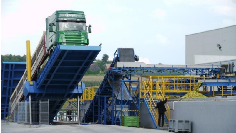
Рисунок 1.2 – Сухе розвантаження сировини
