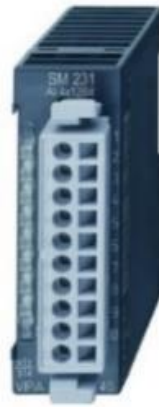
Рисунок 2.7 – Модуль аналогового вводу VIPA 231-1BD40
