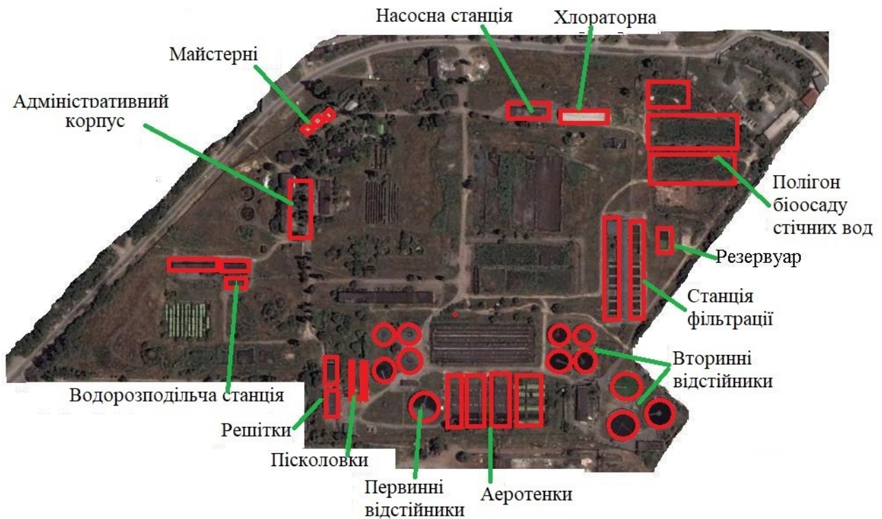
Рисунок 1.1 – Комплекс очисних споруд ЛСА
