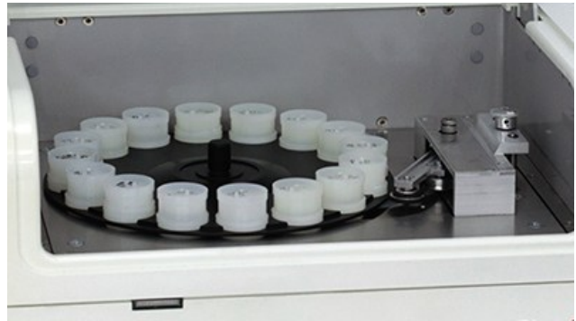
Рисунок 2.2 - Настільний спектрометр ElvaX компанії «Єлватех» (Україна)
