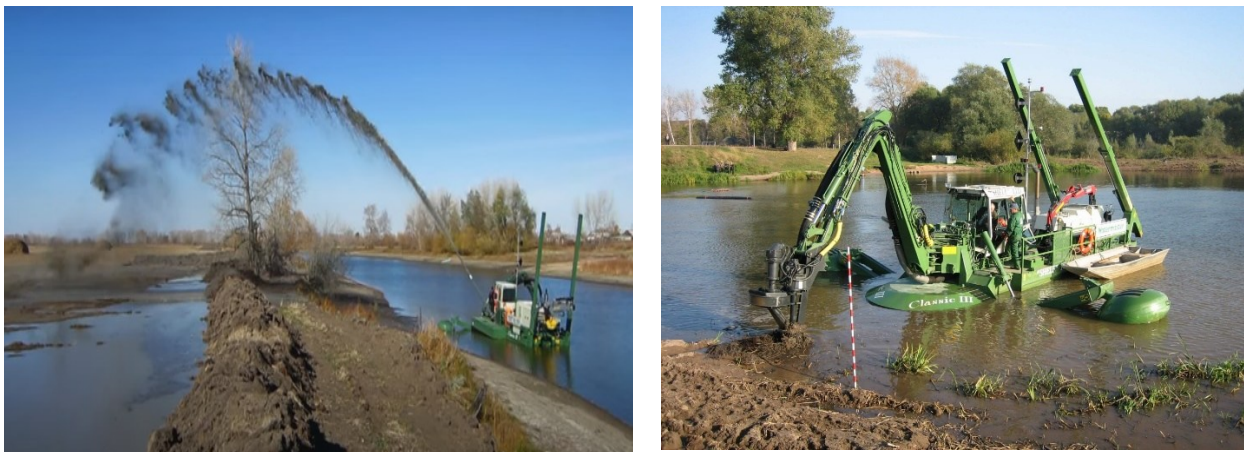
Рисунок 3.1 - Багатофункціональний земснаряд - амфібія Watermaster
