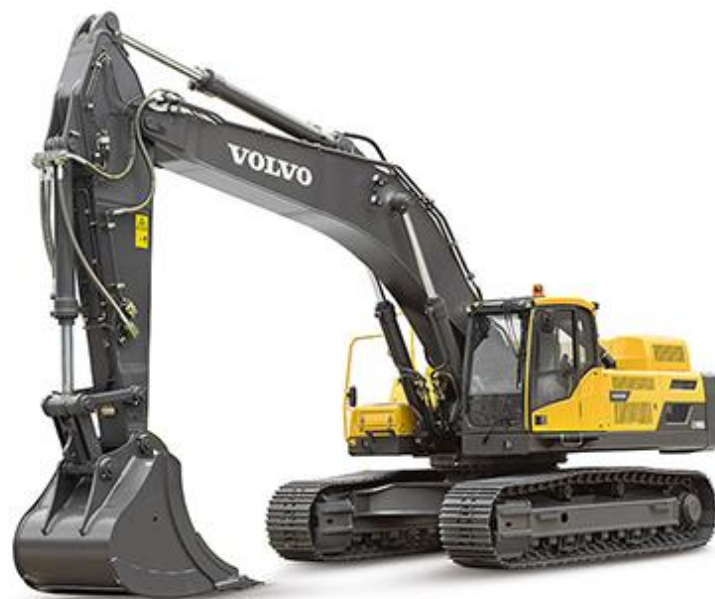
Рис.3.3. Екскаватор гідравлічний обернена лопата Volvo EC380
