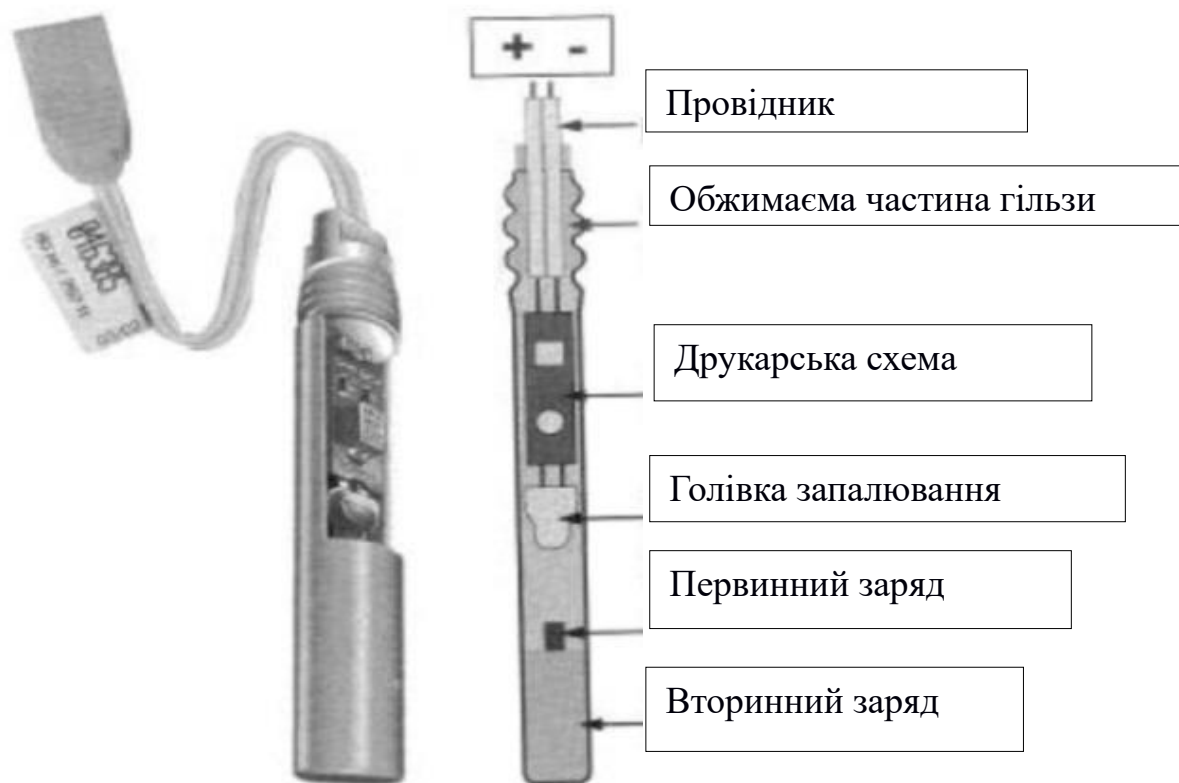
Рис. 3.13. Електронний детонатор i-kon™
