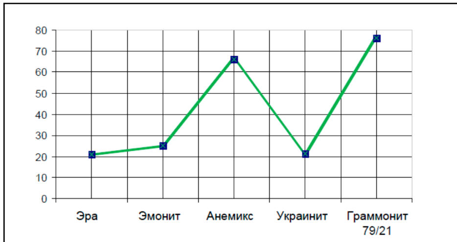
Рис. 3.11. Максимальний об'єм токсичних газів при вибуху ВР, л/кг
