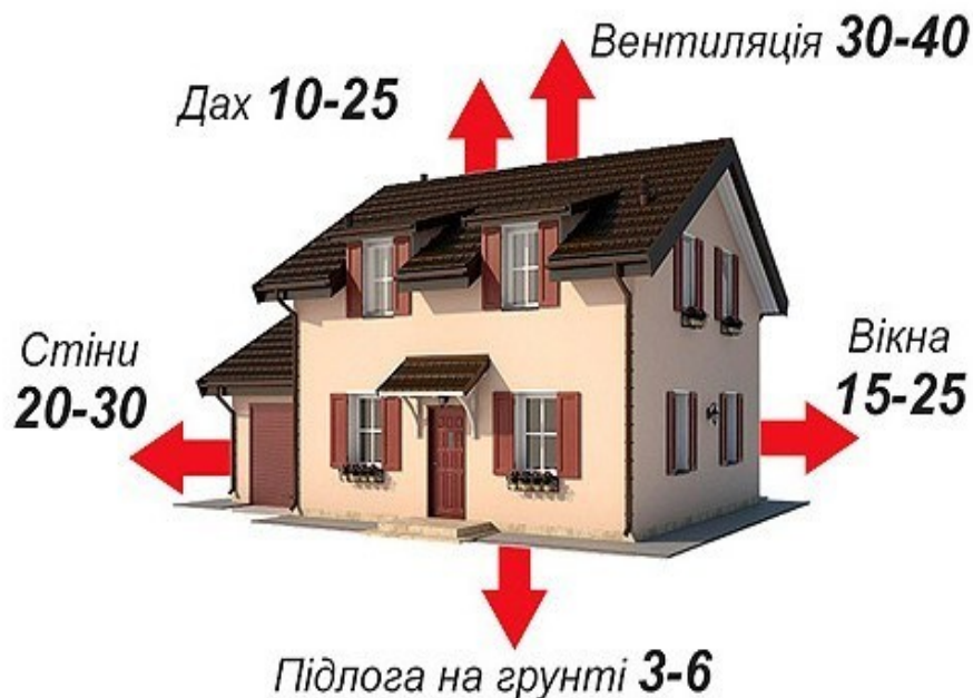
Рисунок 1.5 - Типова схема втрати тепла в традиційному будинку
