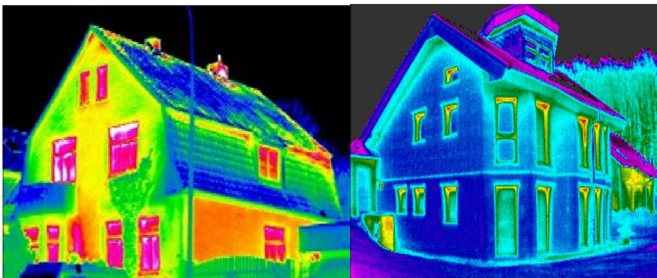
Рисунок 1.2 - Для порівняння тепловтрат термограму звичайного і пасивного будинку (тепло-втрати пасивного будинку близькі до нуля, при такому самому температурному режимі звичайний будинок опалює повітря вулиці)
